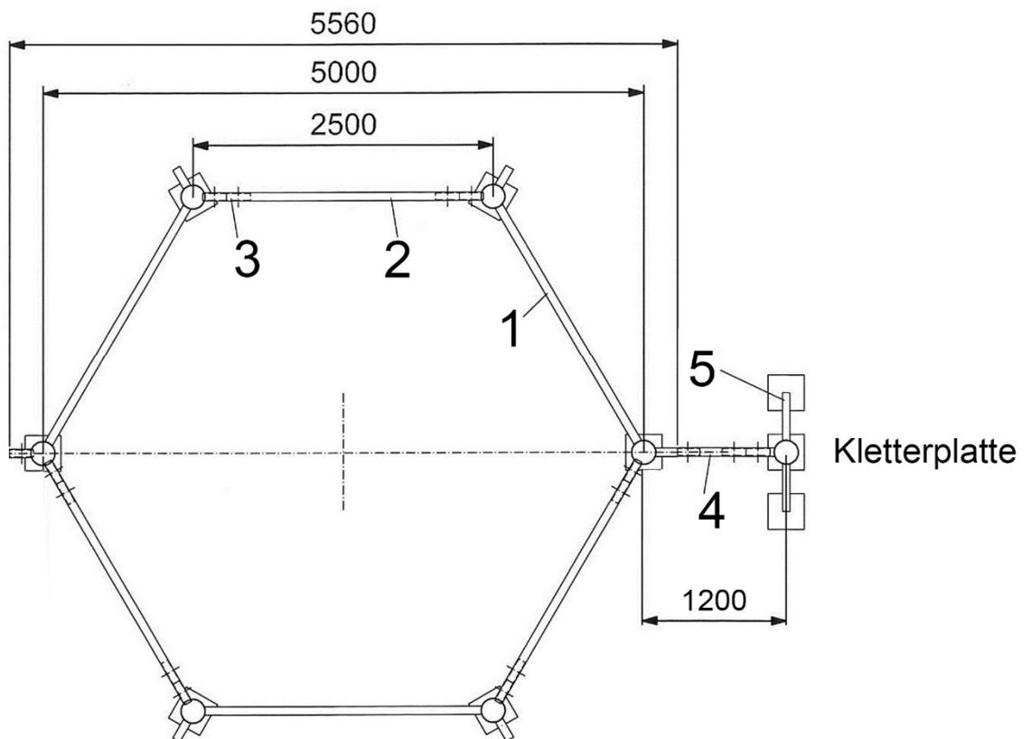
**Abb. 2 – Montage Ankerrahmen**
