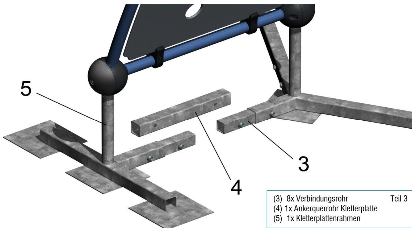
**Abb. 3 – Montage Kletterplattenrahmen**
