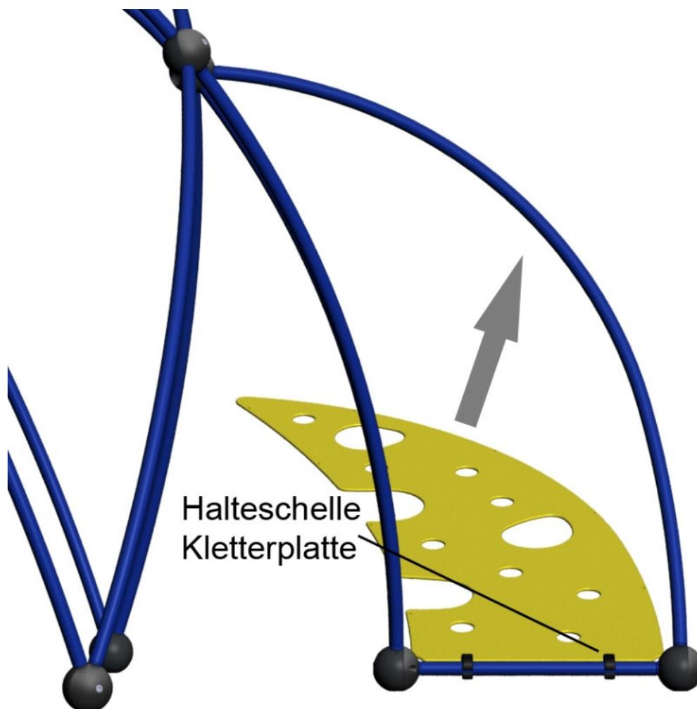
Abb. 16 – Montage der Kletterplatte
