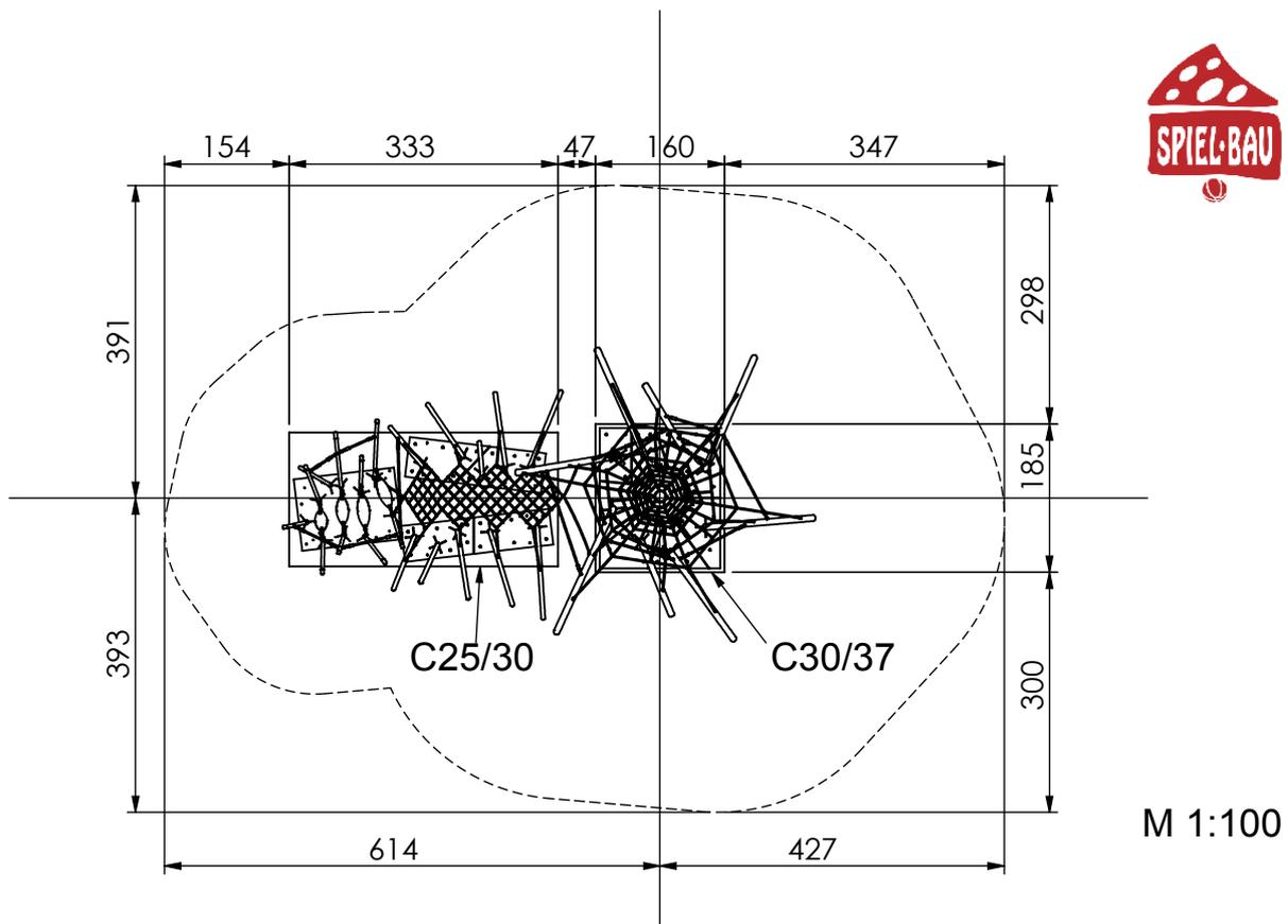
**Fundamentierung: Ortbeton C25/30 bzw. C30/37**
